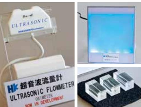
人工呼吸器に組み込まれる超音波流量計。(写真左)
