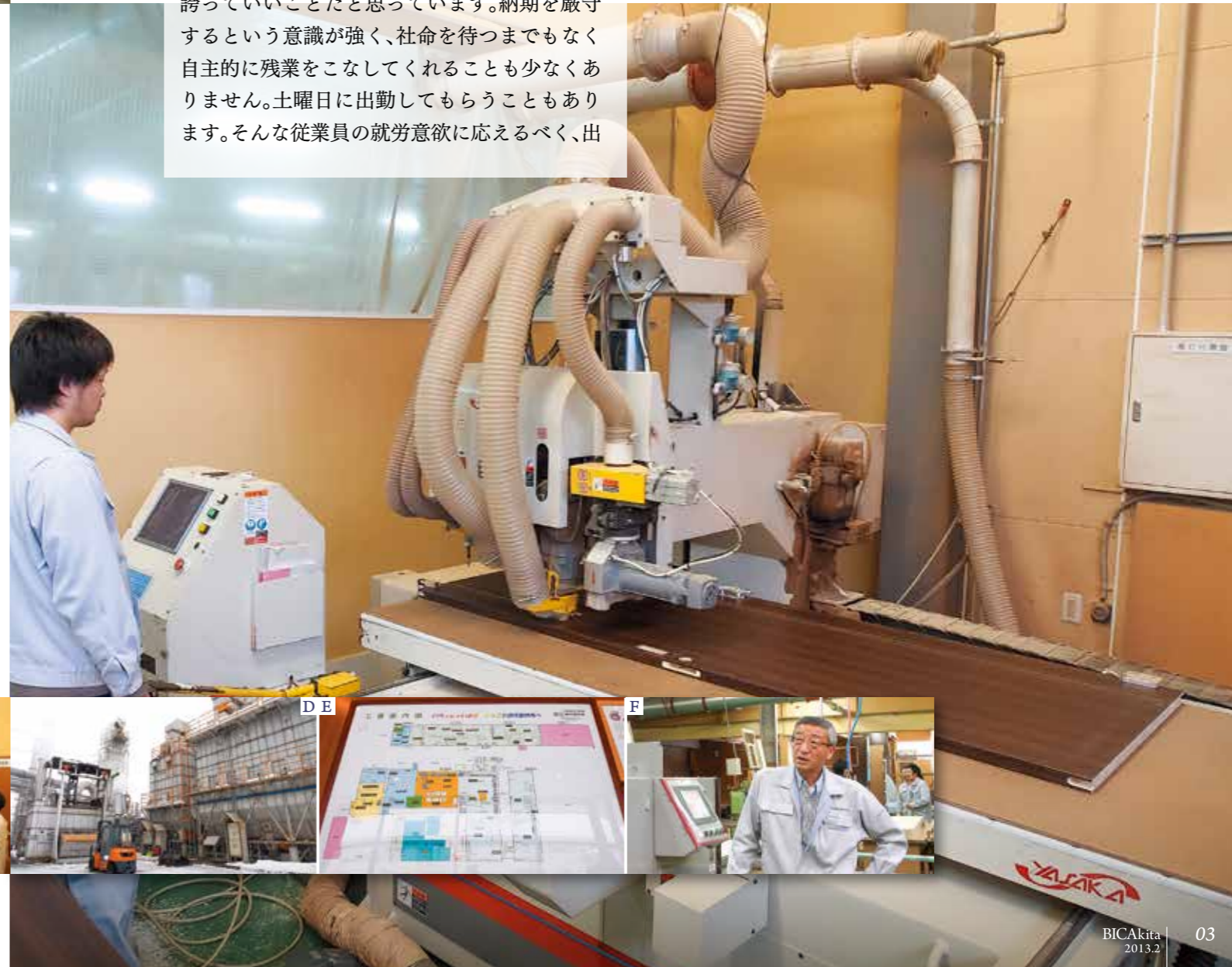
自動機の工程はドア一枚ごとに数値を入力しての作業になる。
