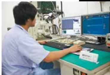
熟練工の目だけでなく、最新の解析機器を豊富に取りそろえているのも同社の特長。めっき液と排水中の金属濃度を分析できるシステムや、表面処理皮膜の厚みと成分比を測定する装置などがある。
