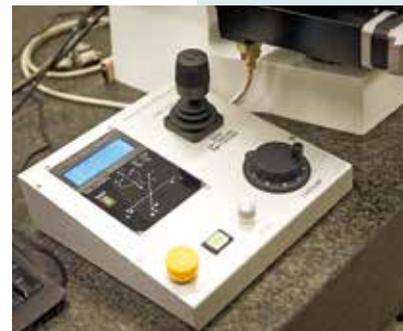
パソコンにUSB接続するだけで、ソフトや硬さ試験機を制御できる。硬さ試験以外にも使える汎用性の高さが魅力。
