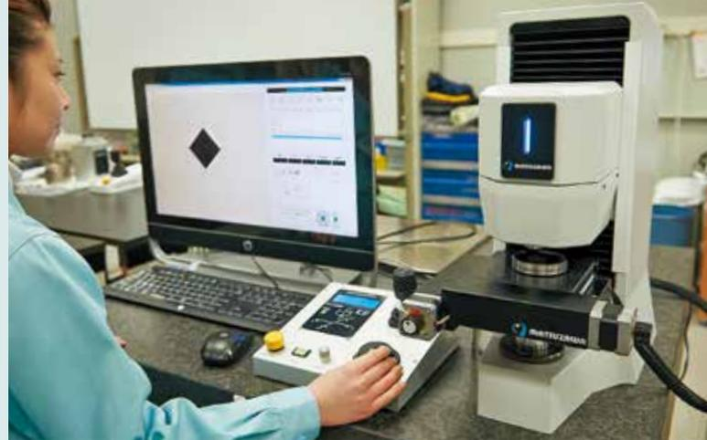
「あきた企業応援ファンド事業」を活用して開発した「多軸モーターコントローラー」(写真中央)。写真右は硬さ試験機。中央部の多軸ステージ開発も同事業の活用による。硬さ試験機そのものは、主に鉄鋼や自動車のメーカー、工業系の研究施設や学校で使用されている。
