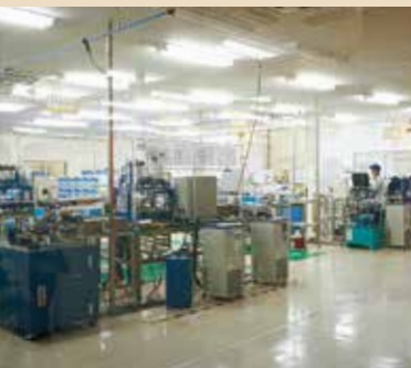
本荘工場の製造ライン。自社製造の「素子」と部品を組み立てて、各種検査を経て出荷となる。
