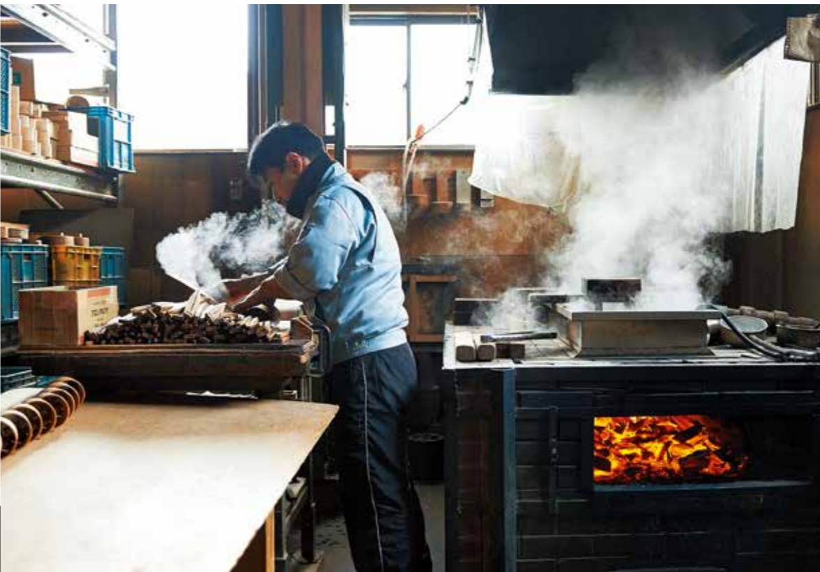
「曲げ」の工程。秋田杉の柃目部分を薄く剥いで板状にし、沸騰させたお湯に入れ30分煮込んで柔らかくする。取り出したら型に合わせて素早く曲げる。天杉の供給が断られたこれからは、人工杉の中から良い材質を選び、品質を維持することも重要になる。
