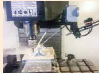
金型の立体部品をCADで描き、加工機(マシニングセンター)で切削。
