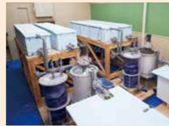
本社内に設置して実証試験中のヒートポンプを使った「あわび養殖システム」。
