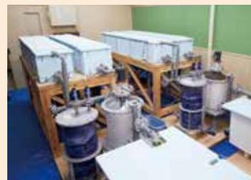
本社内を設置して実証試験中のヒートポンプを使った「あわび養殖システム」。
