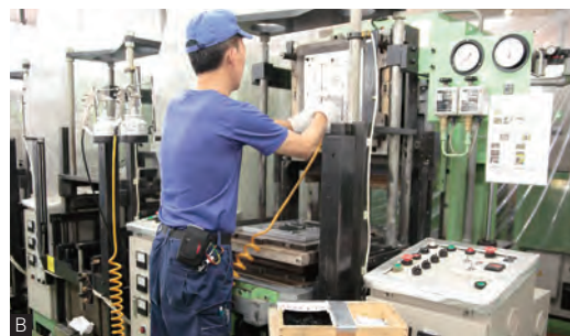
A 用途に合わせて、さまざまなサイズや性能をもつミニOリング B 製品形状やニーズにあった金型で製品を形状加工する成型作業
