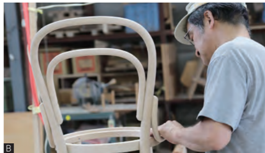
A 高温の蒸気で蒸された木材を、職人が手の感覚だけを頼りに曲げていく B 創業当初から作り続けているダイニングチェア
