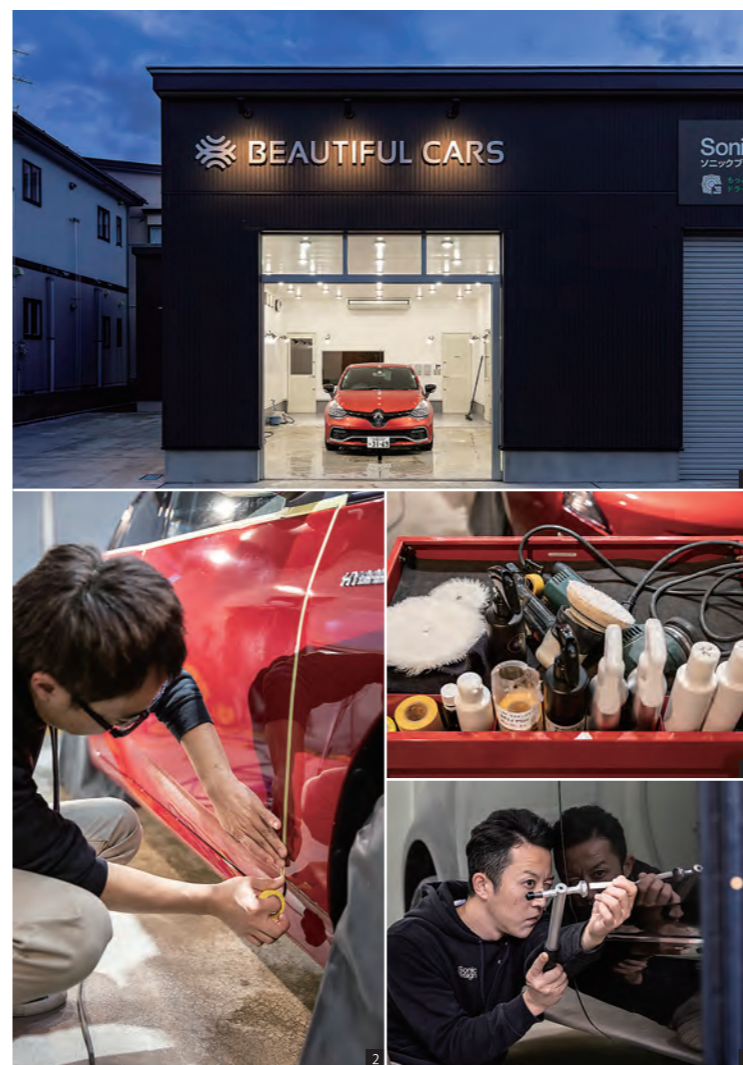
1 洗車用のガレージ。施工を受けた顧客であれば自身で洗車のためにレンタルすることもできる。 2 研磨作業前には隙間をマスキングテープで養生。丁寧な作業が仕上がりの美しさの秘訣。 3 作業は全て選び抜いた“車のために良い道具”を用いて行われる。 4 塗装することなく、裏側から特殊な工具で凹みを押し戻す「デントリペア」技術。表紙 研磨を行う村上代表と「村上塾」塾生の小山さん
