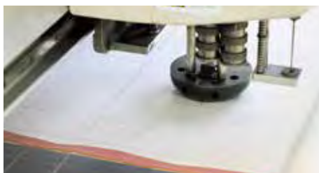
自動裁断機の導入により、 データ入力のみで試作品も簡単に製作できるようになった。
