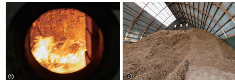
① 軽石を乾燥させるプラント。木製チップを燃やしている様子が見える。 ② 大量に積まれた木製チップ。1日で4トンが使われる。
