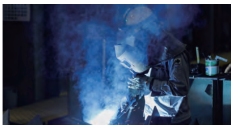
鉄構工場の様子。溶接の作業が行われている。ここでは大きな橋梁の部品などが製造されている。
