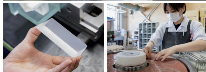
内視鏡のレンズ加工を始め、医療機器のレンズ加工やセンサー接合なども行っている。ミクロンという単位でのセンサー接合は、三井光機製作所が誇る技術だ。
