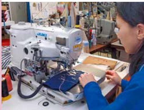
あきた企業活性化センターの設備貸与制度を利用して導入した電子鳩目かがりミシン。
