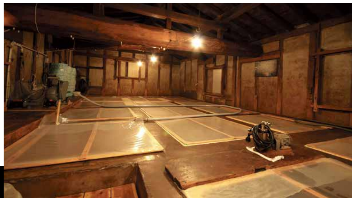
今なお使い続けている土蔵造の発酵蔵。タンクごとに発酵の具合をみながら空気を入れたり攪拌して熟成を待つ。天然での醸造は、平均で丸1年、長いもので2年以上の発酵期間が必要。
