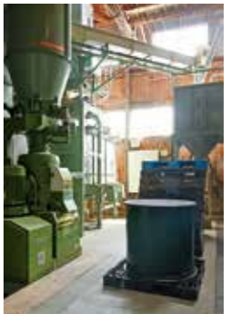
高さが6メートルにも達する精米機。輸送コストや保管コストなどがかることもあって、自家精米を行う蔵は徐々に減っている。同蔵では自家精米も重要な工程と位置付け、「精米土」が100時間以上の時間をかけて精米している。
