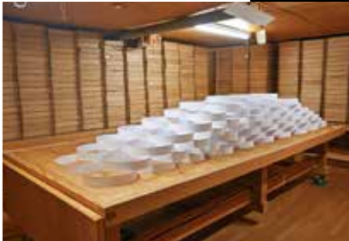
麴室は、めずらしい二階建て構造。4室に仕切られ、それぞれの室温を変えて繊細な温度管理をしている。写真の白い輪っかは、麴の分量を量る道具。昔ながらの麴蓋(こうじぶた)も多くならぶ。
