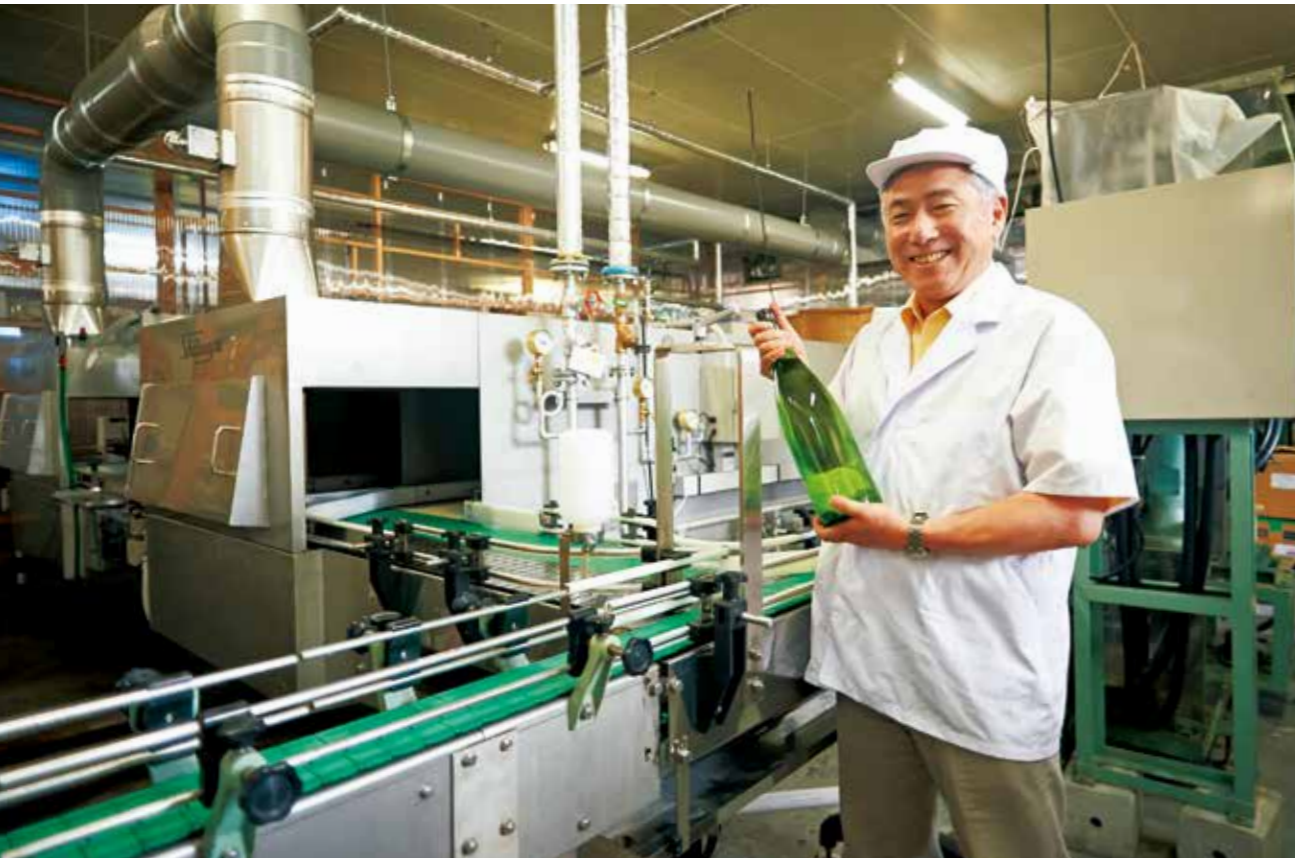
「パストライザー」の横に立つ佐藤社長。火入れ(殺菌)を自動的に行う機械。生詰めした瓶をベルトコンベヤーで移動させながら65度になるまで加熱殺菌する。
