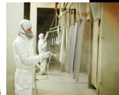
白い防護服に身を包み、塗装ブース内で塗装作業を行う。溶剤塗装、粉体塗装、模様塗装など多彩なニーズに合わせた塗装が可能。
