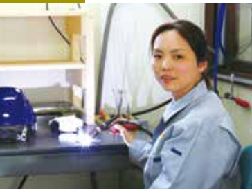
同社が行っているのは「TIG(ティグ)溶接」。強い光を放つが火花が飛び散ることはない。
