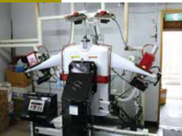
設備貸与で導入したYシャツプレス機。両袖をピンと伸ばし、蒸気を出しながらプレス。パリッと美しい仕上がりになる。
