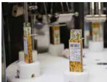
新しく導入した充填機で、冷え固まる前の羊羹をパッケージに注ぎ入れる。
