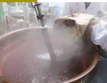
設備貸与制度を利用して更新した機械で餡を練る。熱伝導が良く、むらなく熱が入る銅鍋が欠かせない。
