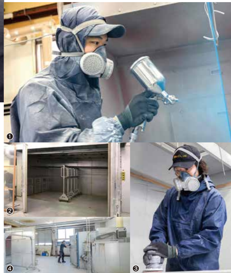
①集中して塗装を進める技能実習生のトゥンさん。②5000mmの製品まで焼き付け塗装が可能な乾燥炉を設置。③丁寧な研磨が美しい仕上がりに繋がる。④工場内は環境管理が徹底されている。
