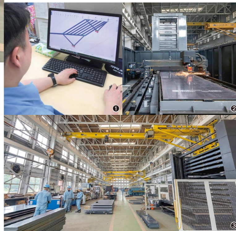
①最新の3D-CADシステムを駆使し顧客のあらゆる要望に応える。 ②働き方改革の一翼を担う、無人稼働のファイバーレーザー加工機。 ③階段創りに必要な全ての部材の加工が行われる第一工場。
