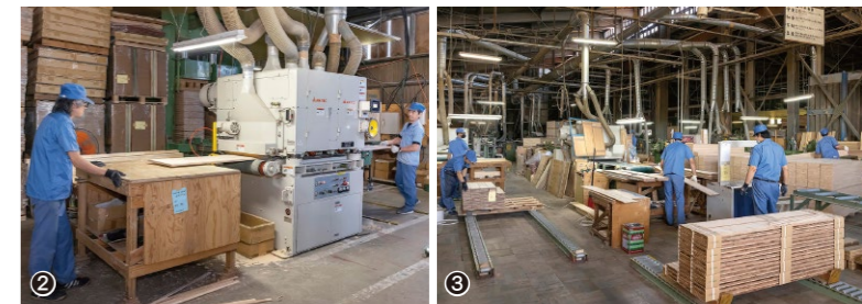
①木材加工にも高精度な技術が求められる。 ②プロテクション・ネオシリーズ加工の第一段階。合板の研磨を行う。 ③加工工場での最終検品後、塗装工場へ。
