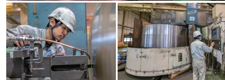
チタンドラムの製造を担う第二工場。高度な技術で成形や外径の切削を行う。
