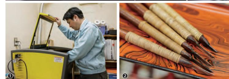
① A3判までの平面に加工が可能なレーザー加工機。ゴム印製造のノウハウを活かすために導入。
