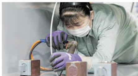
塩ビダクトは鉄板ダクトに比べ高価だが、酸に強く腐食しにくい特徴を持つ。製造には高い溶接技術が必要だ。
