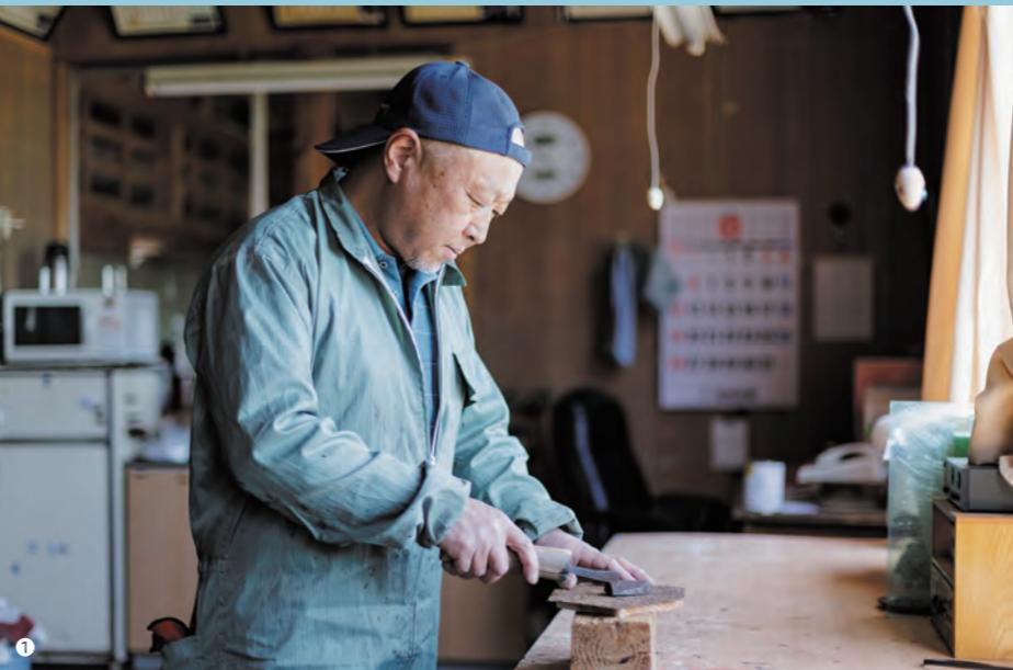
①樺細工の加工には熟練の職人の手作業が欠かせない。取材時は、高温に熱したコテを使い、丁寧に樺を貼り合わせていた。
