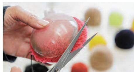
何度か試作を重ね、現在は球体に近い形に。中にボンボンを入れ、治具に沿ってハサミでカットして仕上げる。
