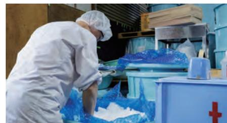
仕込みの日の朝から強力な蒸気で大豆を蒸し上げ、柔らかくしてから潰し、麹や塩と合わせて仕込む。
