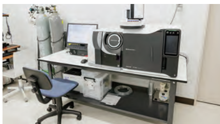
質量分析計(マスペクトロメトリー)により物質を特定し、その量を測っている。
