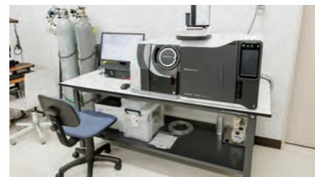
質量分析計(マススペクトロメーター)により物質を特定し、その量を測っている。
