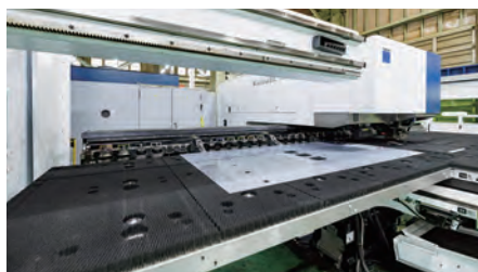
ドイツ製のファイバーレーザー複合機を使うようになり、今まで手作業だった段取り時間がなくなり効率上がった。
