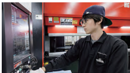
新型の曲げ設備では、ネットワークでデータを共有している。作業者が代わっても品質の良い部品が完成する。
