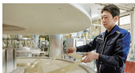
粗削りの作業を施した平面ガラスを専用機械に並べ、 研磨作業を行う。
