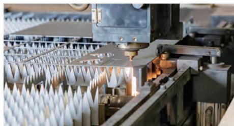
図面を元にレーザーで金属板を加工している。
