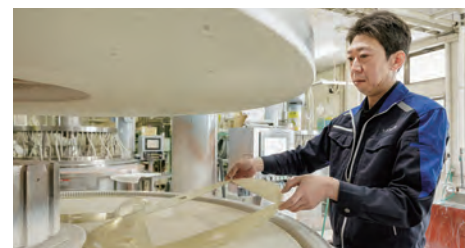
粗削りの作業を施した平面ガラスを専用機械に並べ、研磨作業を行う。
