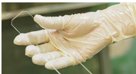
磨き上げられた平面ガラスを精製水で洗浄する。丁寧に洗浄されたガラスは一点の曇りもない。
