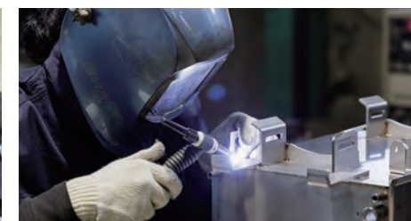
折り曲げられた金属板を溶接で繋ぎ、完成に近づけていく。
