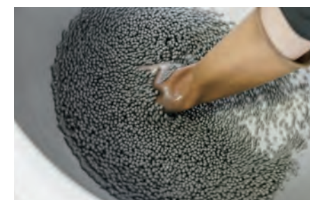
花火の火薬を配合する作業。一見すると同じように見える火薬だが、配合によって色合いは異なる。
