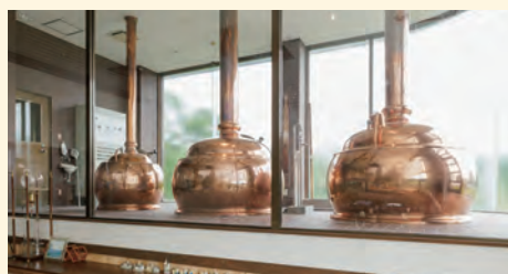
通常、ビールの醸造所は2釜方式だが、ここでは米を糖化させるための専用釜も設置されている。
