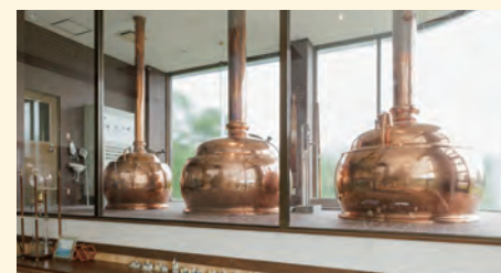
通常、ビールの醸造所は2釜方式だが、ここでは米を糖化させるための専用窯も設置されている。
