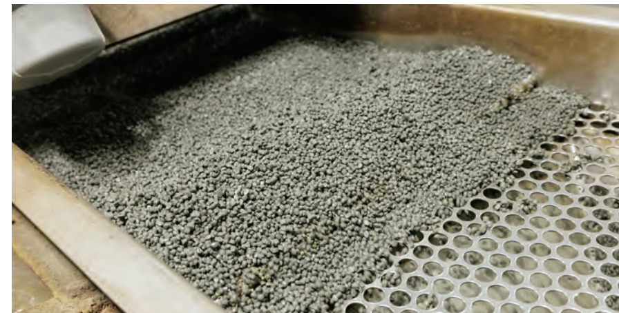
再生プラスチックの原料となるペレットの製造を行っている様子。
