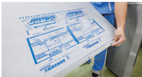
設備貸与の制度を活用して更新したCTPで作った版。 印刷業にとっては、必要不可欠の設備だ。
