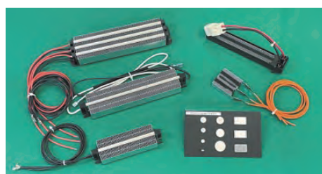
PTC素子をモジュール化した「PTCヒータ」は、車だけでなく浴室暖房やハンドドライヤーなど幅広く使われている。
