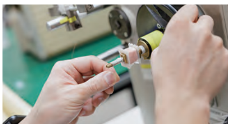
大小、銅線の太さなどコイルの種類は多種多様。工場内にはさまざまな巻線機がある。
