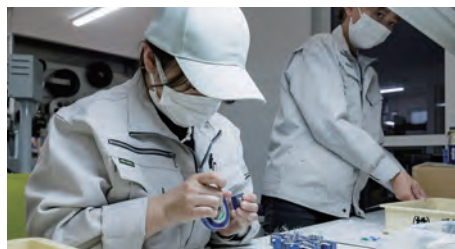
出荷前にはトランスの検査項目をチェック。これもトランスの品質を確保するためには必要不可欠な工程だ。
