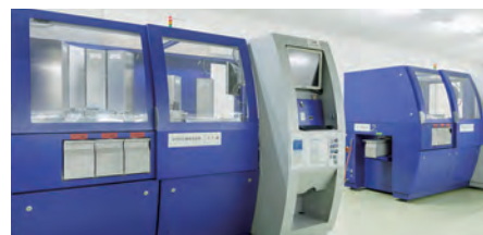
小サイズの製品は光学式自動検査装置で検査を行う。
