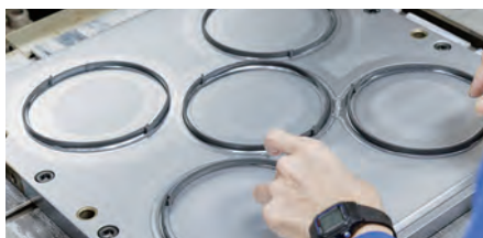
ゴムの製造工程。並べたゴムを圧縮することで成形していく。
