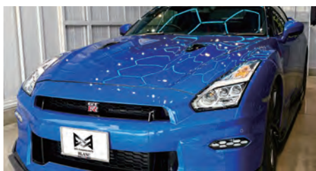
施行ブースには特殊な照明を設置している。 塗装面の細かな傷やムラを見極めるための設備だ。
