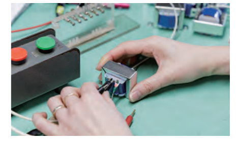
全てのトランスは全数検査が行われる。納品後、取引先では抜き取りでの検査で済むようという配慮だ。
