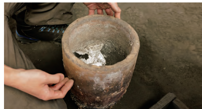
同社では銅合金、アルミニウム、鉄を使う。それらを溶かす黒鉛坩堝。
